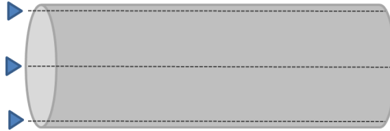
Figura 6. Marcação dos pontos de medição do comprimento ( L ) do corpo de prova.
