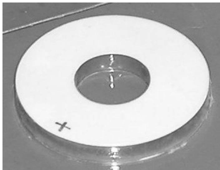
Figura 13. Cerâmica comercial (ATCP) de PZT-5A ( Soft ) com eletrodos de prata e polarizada.
