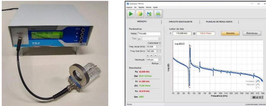
Figura 7 – Analisador TRZ® conectado ao PiezoHolder e o Software TRZ®.
