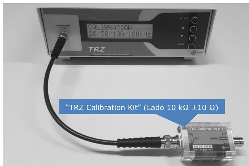
*Passo 03* Pressione o botão [START]. Após 20 segundos será reportado no display o valor do módulo impedância medido na frequência de 20,00 kHz (veja exemplo abaixo). O resultado que deve estar entre 9.700 e 10.300  $\Omega$  ( $\pm 3\%$ ); se estiver fora desta faixa, proceda com o ajuste (próximo tópico). No exemplo da figura a seguir o desvio de 10 k $\Omega$  foi de 250  $\Omega$ , portanto o equipamento está dentro da faixa aceitável e não necessita de ajuste.
