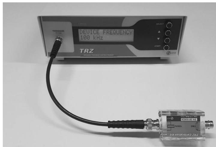
*Passo 02* Realize a medição do ressonador pressionando o botão [START]. Após aproximadamente 15 segundos será reportado no display a frequência de ressonância e o respectivo módulo da impedância ou a frequência de antirressonância e o respectivo módulo de impedância (utilize os botões [▼] e [▲] para alternar entre elas).
