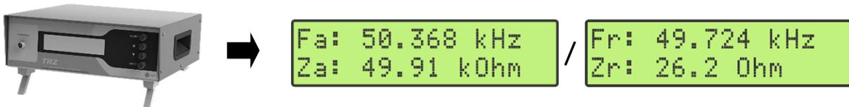
*Exemplo de apresentação de resultados pelo Analizador TRZ®: frequências e módulos de impedância de um transdutor de 50 kHz (a troca entre as telas de resultados é realizada com o pressionar de um botão).*
