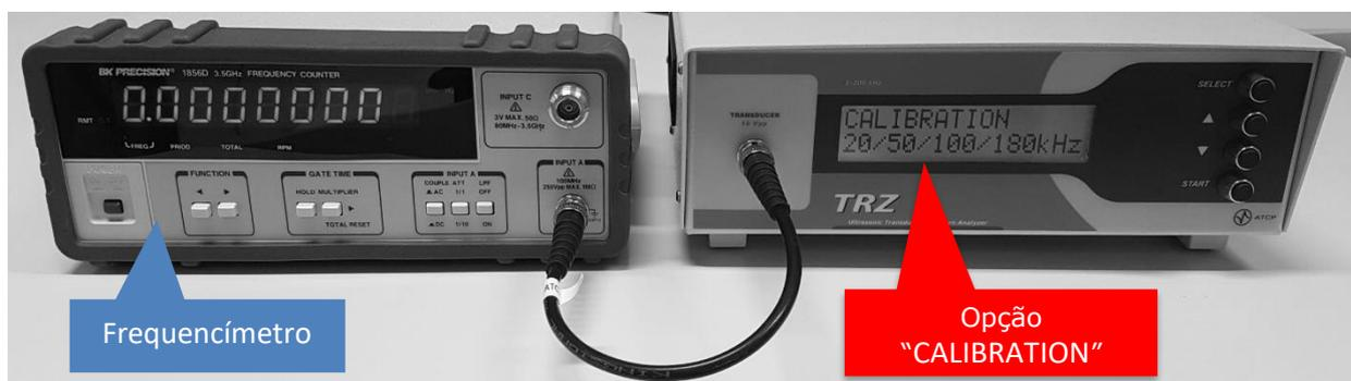
*Exemplo de arranjo experimental para aferir a acurácia da geração de frequência do Analizador TRZ®. A frequência é medida pelo frequencímetro conectado ao Analizador TRZ® no modo "CALIBRATION".*
