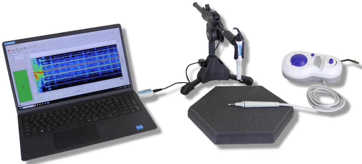
Figura 39 - Disposición para determinar el comportamiento en frecuencia de un raspador dental por ultrasonidos durante el arranque.
