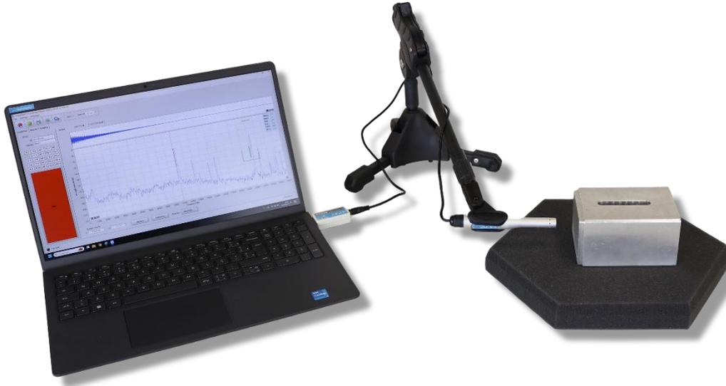
Figura 37 - Disposición para determinar la frecuencia de uno sonotrodo rectangular de 20 kHz para sintonización.
