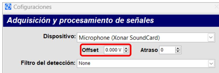
Figura 67 - Sección de ajuste de “Offset”.
