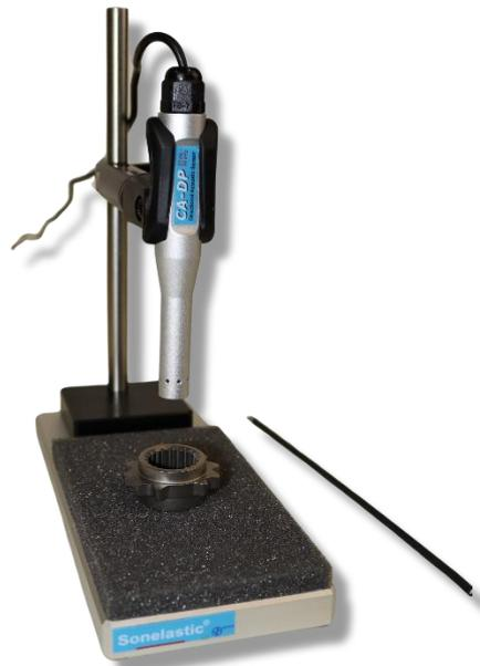
Figura 43 - Disposición del soporte del Sensor Acústico CA-DP y SB-AP para determinar el espectro de resonancia de una pieza de polvo metálico sinterizado.
