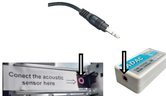
Figura 13 - Sensor acústico TRS P2 / conector de 3,5 mm, entrada de audio de una placa de adquisición XONAR instalada en el panel posterior de una computadora DELL y entrada de audio del módulo de adquisición ADAC.
