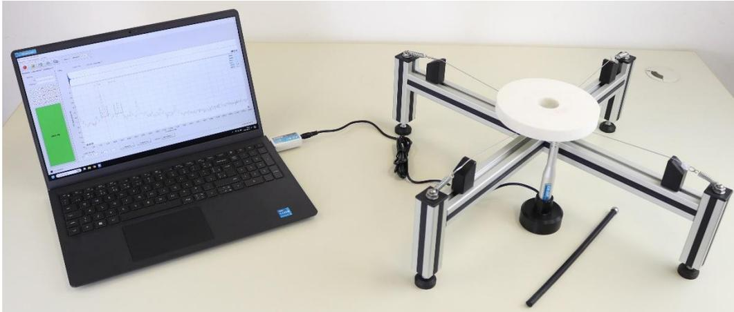
Figura 45 - Disposición del sensor acústico CA-DP y soporte SX-PD para determinar el espectro de resonancia de una muela pequeña.
