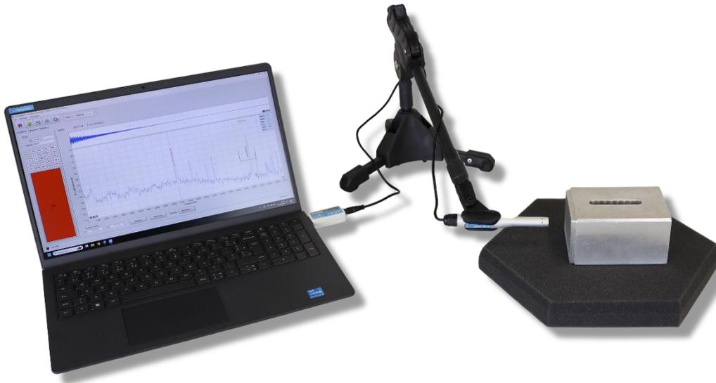
Figura 37 - Arranjo para determinação da frequência de um sonotrodo retangular de 20 kHz para o processo de sintonia.
