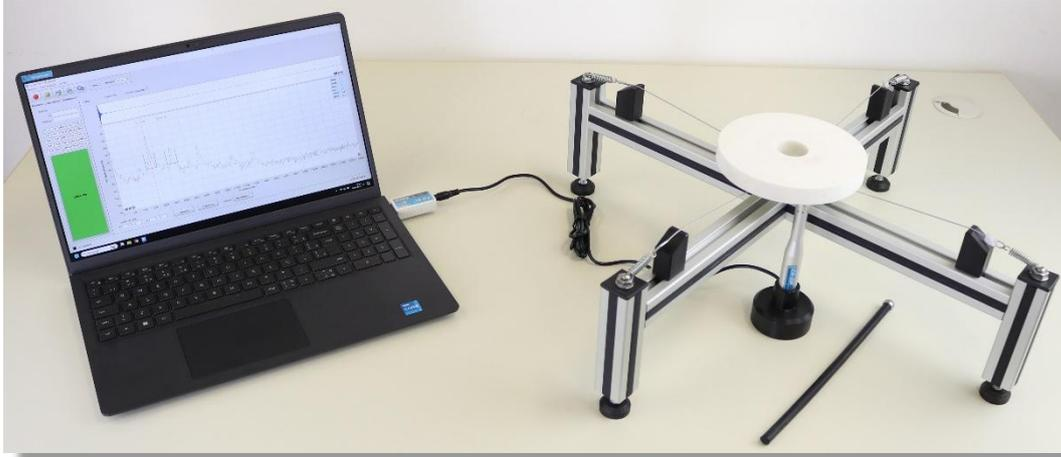
Figura 45 - Arranjo do Sensor Acústico CA-DP com o suporte SX-PD para determinar o espectro de um rebole.
