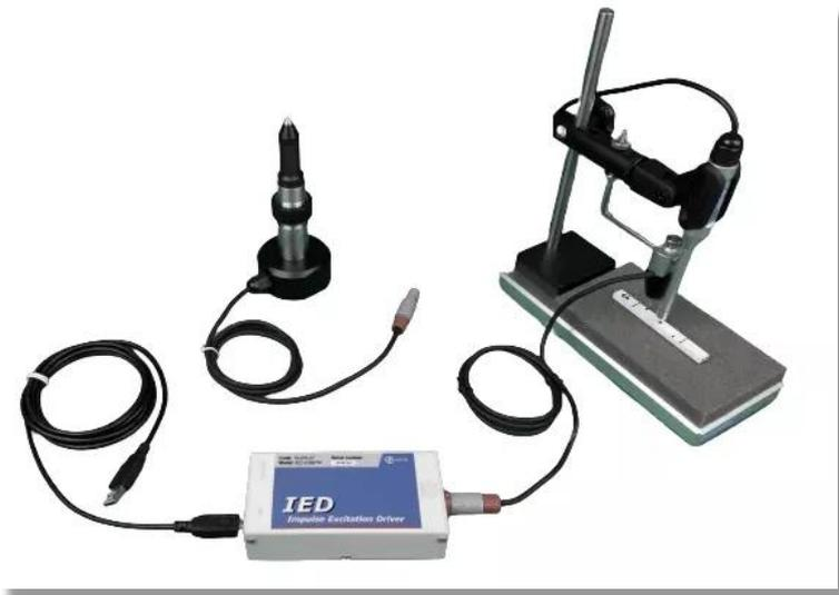
Figura 24 – Pulsadores automáticos da ATPC Engenharia Física (Médio e Leve).
