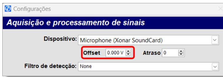
Figura 67 - Seção de ajuste de *offset*.
