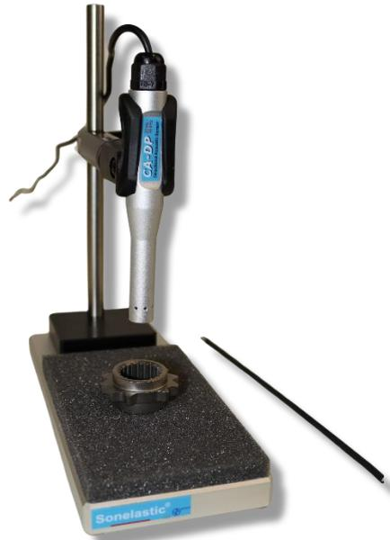
Figura 43 - Arranjo do Sensor Acústico CA-DP e do suporte SB-AP para determinar o espectro de ressonância de uma peça metálica fabricada via metalurgia do pó.
