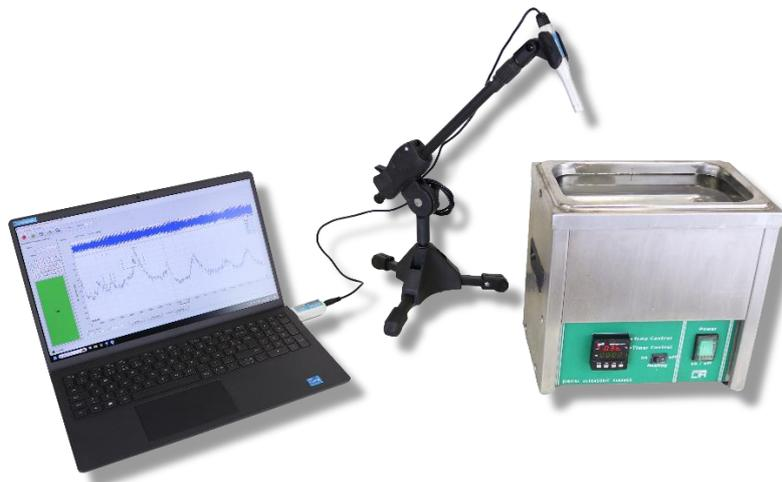
Figura 29 - Arranjo para determinação da frequência de uma lavadora ultrassônica.
