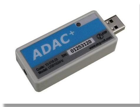
Figura 26 – Dispositivo de aquisição ADAC+, desenvolvido e fabricado pela ATPC Engenharia Física. A taxa de amostragem máxima do ADAC+ é de 384 kHz.
