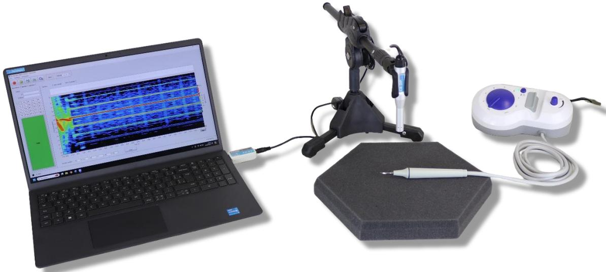
Figura 39 - Arranjo para determinação do comportamento da frequência de um *scaler* odontológico ultrassônico durante a partida.
