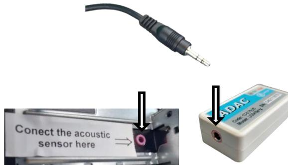
Figura 13 - Conector TRS P2 / 3,5 mm do Captador Acústico CA-DP-S e entrada de áudio da placa de aquisição XONAR, instalada no painel traseiro de um computador DELL, e do módulo de aquisição ADAC.
